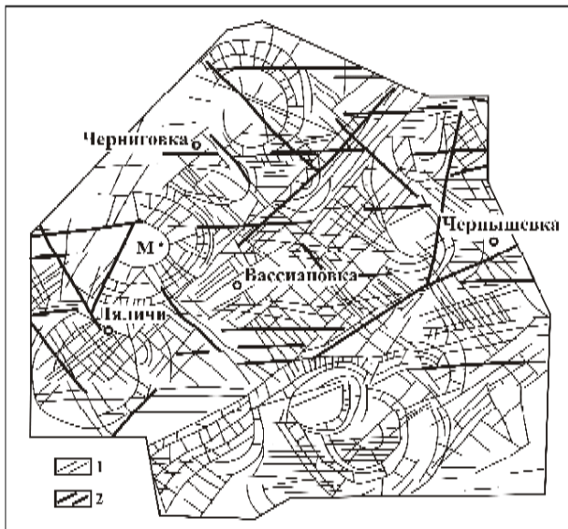
Рис. 1. Схема дешифрирования линейных элементов рельефа на топопланах масштаба 1:50 000–1:100 000 и размещения линейных градиентов гравитационного поля Южно-Синегорской вулканотектонической депрессии [4]: 1 – линейные элементы рельефа, 2 – линейные градиенты гравитационного поля
