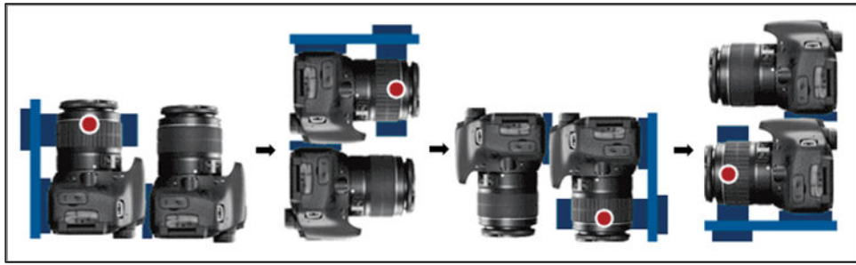
Рис. Вращение двух камер на одной панорамной головке
